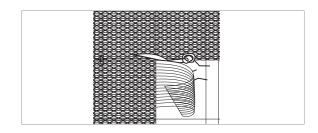
En el caso de los vértices de puertas y ventanas o cualquier otro ángulo recto, estos se deben reforzar utilizando trozos de la misma malla.
