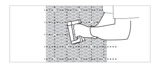
Los cortes que sean necesarios realizar en la malla, como por ejemplo vanos de puertas, ventanas y otros, se deben realizar cuando la malla se encuentre tensa y fijada a la superficie.
