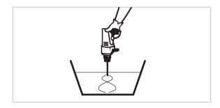
El mortero PRESEC R65 ESTUCO OSB viene listo para su uso y sólo se debe agregar agua. En ningún caso se le deben agregar aditivos o adiciones.
