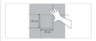
Para fijar el fieltro al tablero LP OSB se deben colocar corchetes de 10 mm. cada 30cm. como máximo. En el centro del fieltro debe ir un corchete para evitar el englobamiento.
