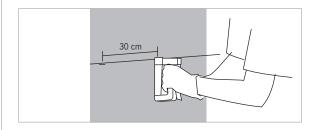
Tome todas las precauciones necesarias para evitar infiltraciones por uniones y encuentros, traslapando correctamente las capas de fieltro y evitando perforaciones, ya que luego de aplicado el estuco no será posible evitar estas infiltraciones.
