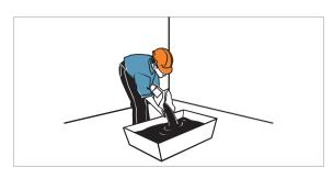
Una vez que la mezcla se torna pesada se debe continuar con el amasado en forma mecánica. Se recomienda utilizar un mezclador acoplado a un taladro de bajas revoluciones (máximo 600 rpm) o una betonera.
