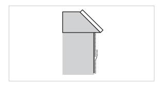
Se debe verificar que en los bordes de la malla no se presente ningún tipo de levantamiento o irregularidad, en caso de existir, se deben colocar corchetes en estas zonas.
